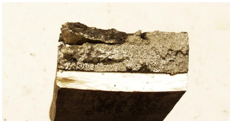
Ábra: A 3. kísérlet vastömbjének töretfelülete
