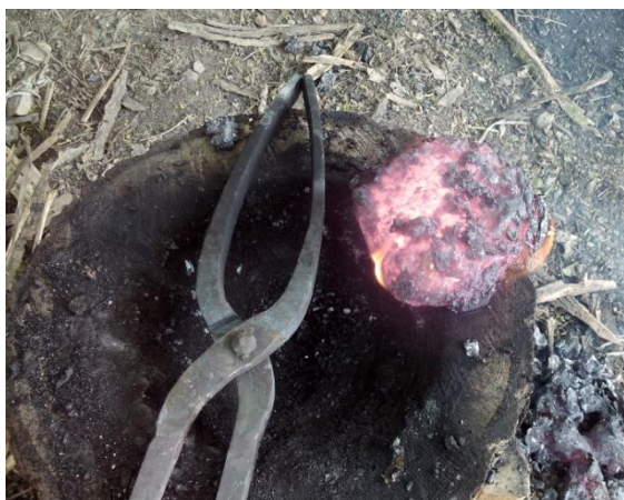
Ábra: A próbakohósítások helyszíne Thiele Ádám erdei kovácsműhelyének udvarán, a hegyoldalon (a). A bucakemence próbakohósítás közben (b). Az egyik tömörített, még izzó vasbuca (c). Egy vastömb kikovácsolása gépkalapáccsal (d).
