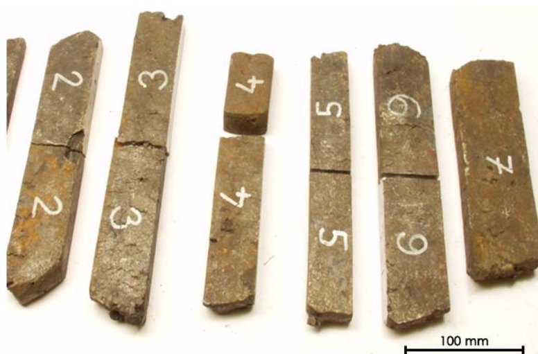
Ábra: a 2-7 kísérletek eredményeképpen kapott vasbucákból kikovácsolt vastömbök
