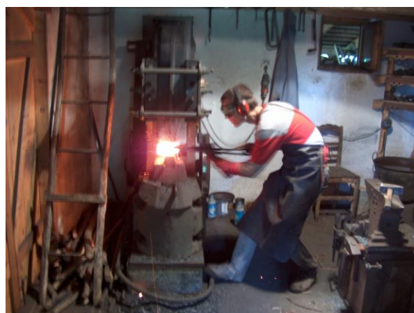
Ábra: A próbakohósítások helyszíne Thiele Ádám erdei kovácsműhelyének udvarán, a hegyoldalon (a). A bucakemence próbakohósítás közben (b). Az egyik tömörített, még izzó vasbuca (c). Egy vastömb kikovácsolása gépkalapáccsal (d).
